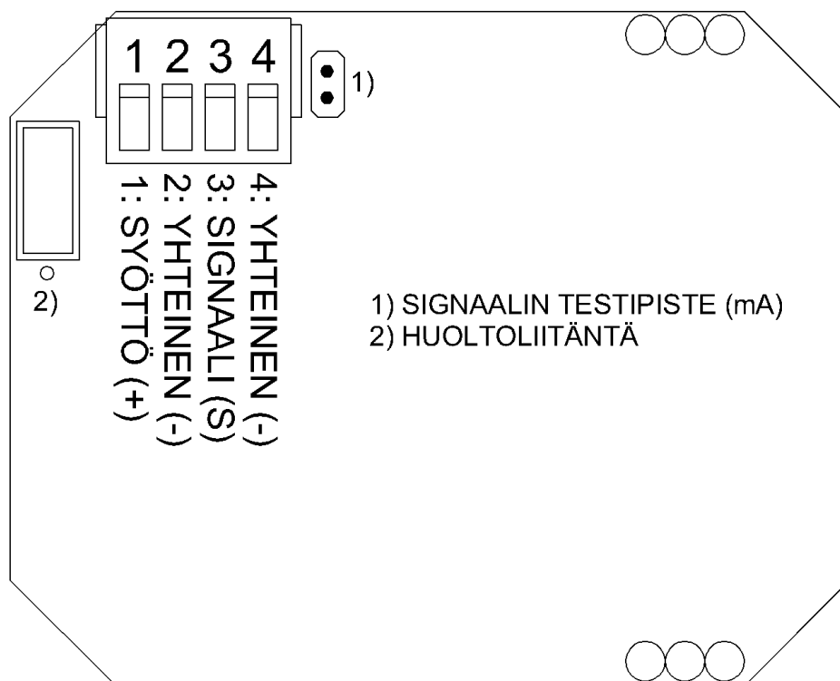
Kuva 16, DGTi2-ex kaasunilmaisimen riviliittimet ja niiden sijoittelu piirilevyllä.
