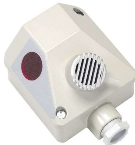
Kotelon mitat 89mm x 89mm x 69mm. Anturin suojaholkien pituus on 20mm. Saatavana myös kanava-asennusvarusteilla
